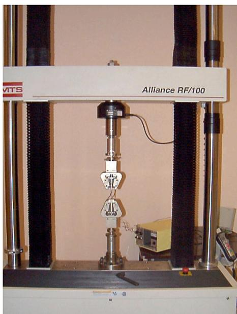
Machine de traction sur éprouvettes
